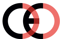
Marcatura CE contraffatta (troppo vicino)
